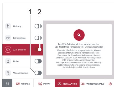
Bild 288 12 V och vattenpump
