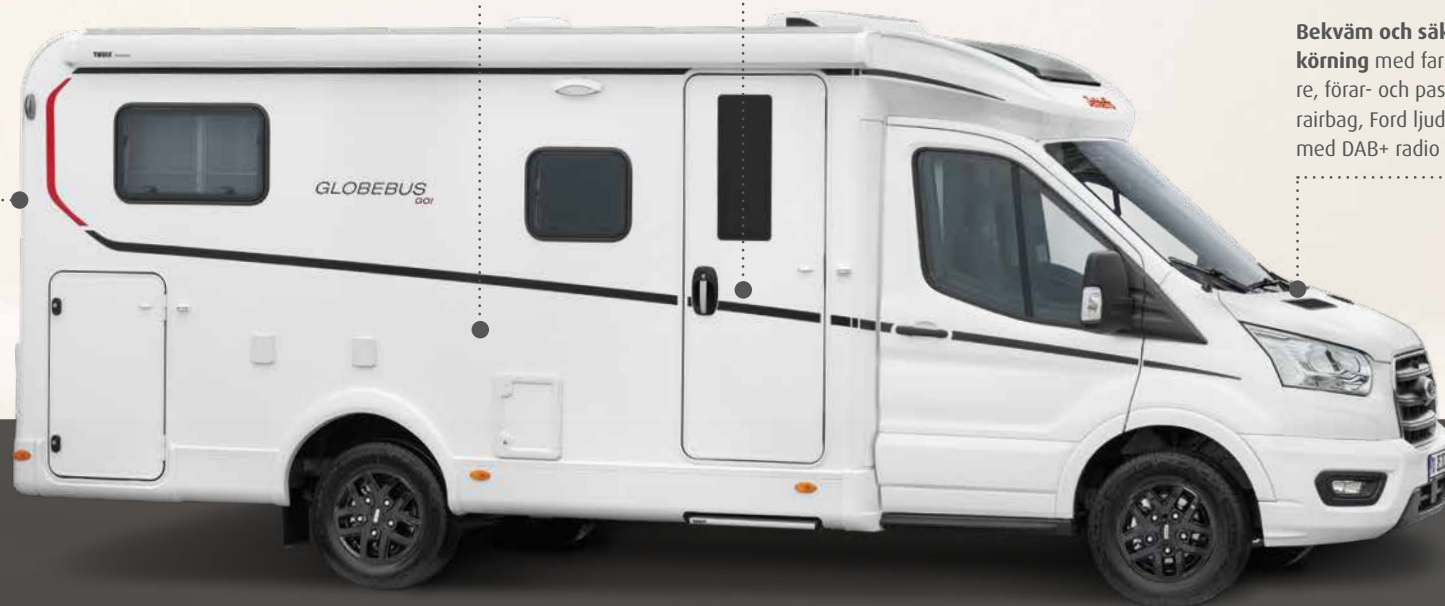
Tak, bak- och sidoväggar av mot- ståndskraftig GFK
