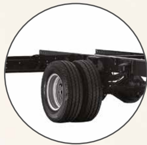
Bakhjulsdrivning med tvillingdäck och luftfjädring av drivaxeln
