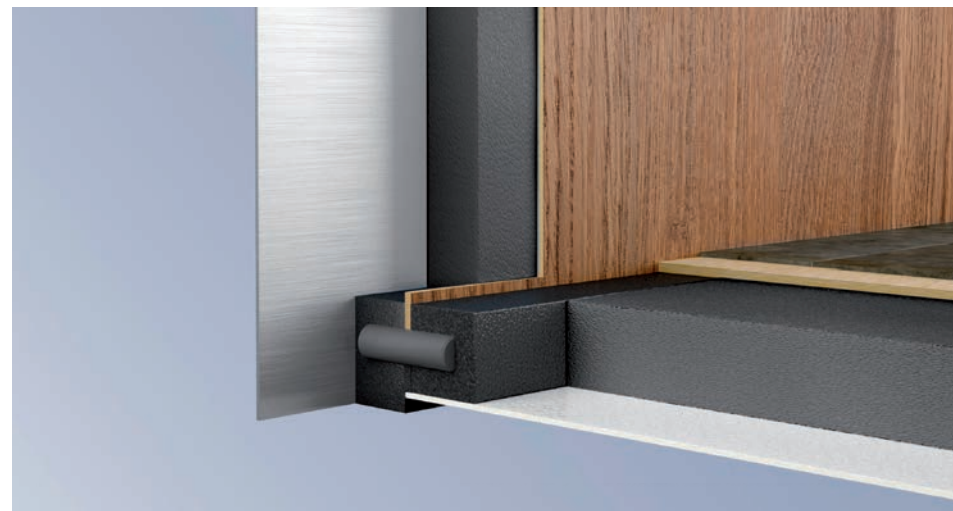
Välisolerad: väggjocklek 34 mm, golvjocklek 42 mm
