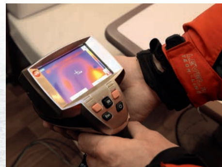
Temperaturen testas med en värmkamera
